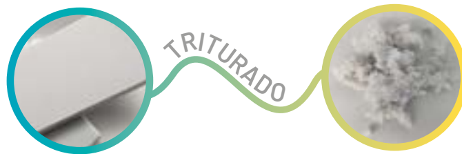
Figura N°15. Triturado de residuos de espuma de melamina.
