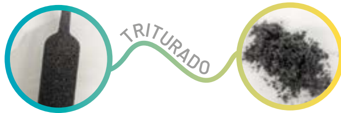
Figura N°9. Triturado de residuo de espuma de polietileno.
